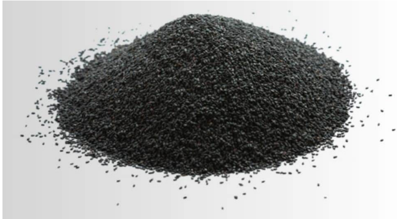
Fig. 5.1.41 Earth electrode backfill material
